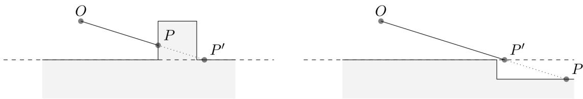
Abbildung 1: Hinderniserkennung durch Vergleich von erwarteter und gemessener Distanzwerte (nach Wagner (2009)). Die erwartete Distanz ergibt sich durch Schnitt des Strahls laut Sensorbeschreibung mit der erkannten Bodenebene (gestrichelte Linie). Ist die gemessene Distanz kürzer, so handelt es sich um ein positives Hindernis (links). Ist sie länger, um ein negatives Hindernis (Loch im Boden; rechts).
